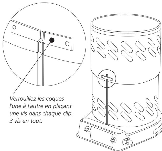
*Verrouillez les coques l'une à l'autre en plaçant une vis dans chaque clip. 3 vis en tout.*
