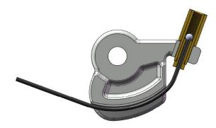
FIGURE 3: PULLEY CABLE ATTACHMENT
